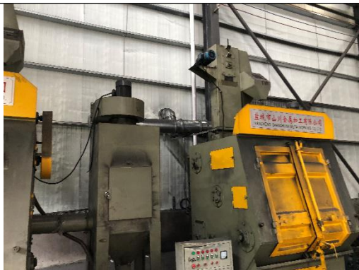
图 3.1 脉冲布袋除尘器
