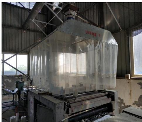
图 3.5 自动切缝印一体机上方集气罩
