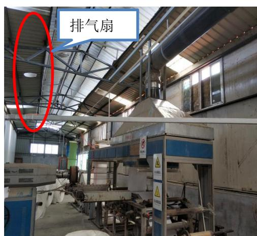
图 3.4 涂膜机上方集气罩
