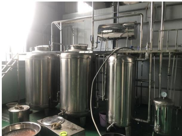
图 3.2 封闭式的中药提取浓缩机组
